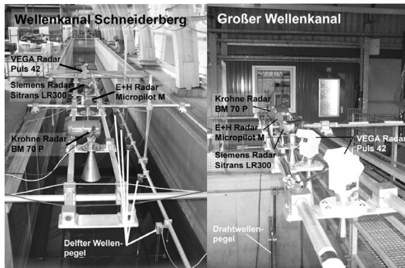
Abbildung 1: Versuchsaufbau im Wellenkanal Schneiderberg (WKS) und im Großen Wellenkanal (GWK).
