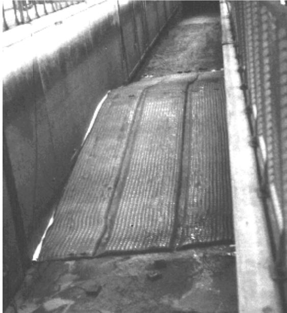
**Bild 3** Blick auf das im *Großen Wellenkanal* eingebaute Modell des Sommerdeichs
