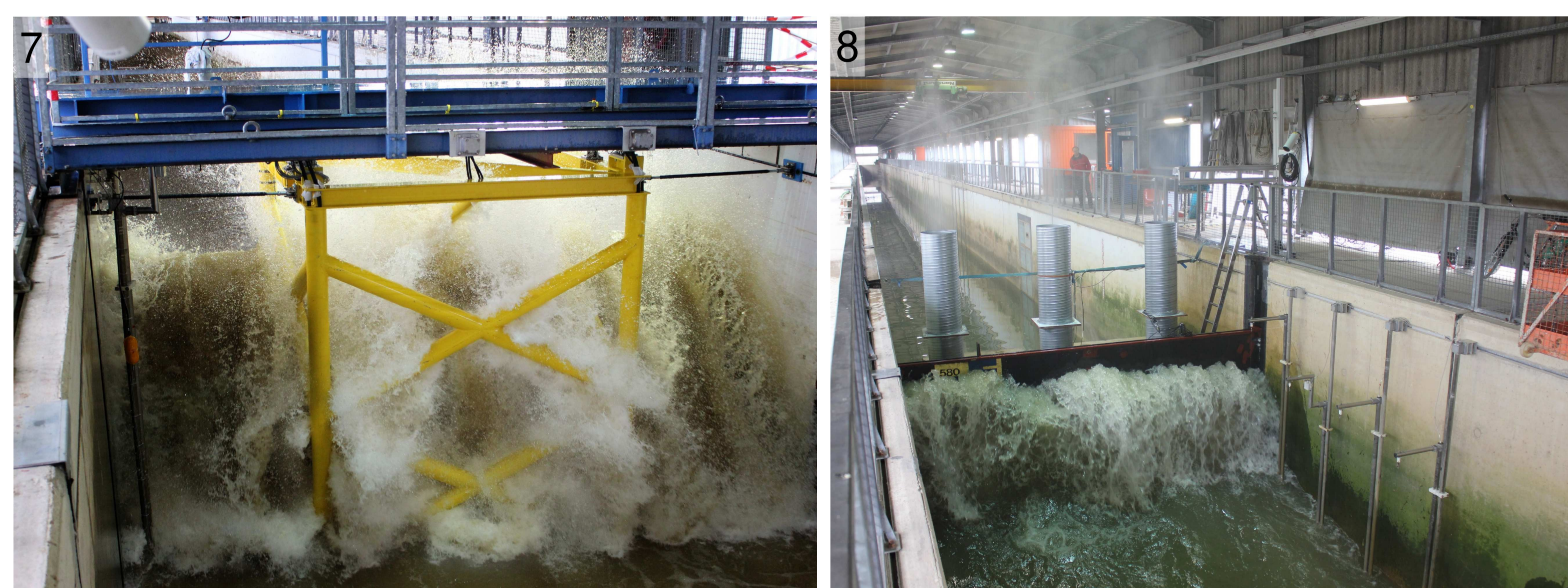
Abb. 7-8: Modellversuche zum Thema Nutzung mariner Energien. 7) Wellenlasten auf Offshore-Windenergieanlagen und 8) Wellenenergieanlagen.
