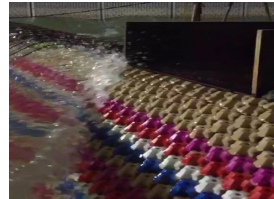
Abb. 1: Wellenaufbau unter schrägem Wellenangriff am Modell im Wellenbecken
