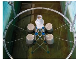
Abb. 3: Draufsicht Versuchsaufbau Orientierung 0°, Jacket mit Auftriebstanks
