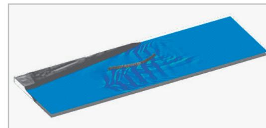
Modellierungsergebnisse der Interaktion von Schiffsinduzierten Wellen mit einer untersuchten Spundwand.
