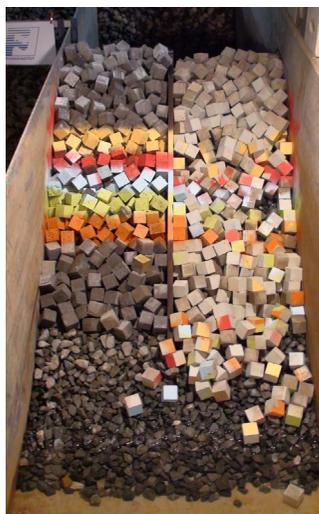
Leistungsfähigkeit einer Wellenbrecherdeckschicht aus Schwerbeton (li.) und Normalbeton (re.) nach ca. 10000 Wellenzügen im Wellenkanal
