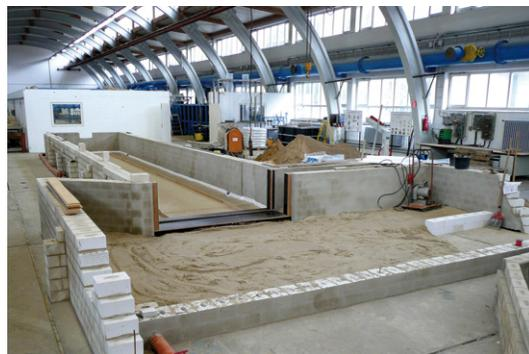
Aufbau des Flächenmodells im Maßstab 1:25
