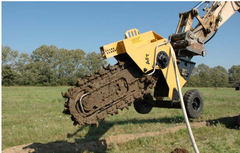
Abb. 3: Funktionsmuster der mobilen Schlitzfräse mit Injektionseinheit
