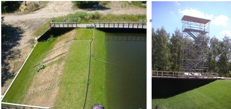
Abb. 1: Anlage des Labordeichs mit Einstau (links) und Kameraturm (rechts)
