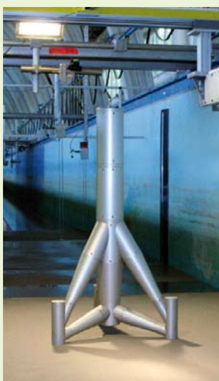
Abb3 Modellaufbau im Wellenkanal WKS zur Kolkuntersuchung im Maßstab 1:40
