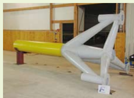
Abb5 Modelltripod für die Versuche im Großen Wellenkanal im Maßstab 1:12
