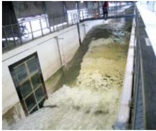
Im 330 Meter langen Wellenkanal schwappt eine Welle auf den künstlichen Deich.
