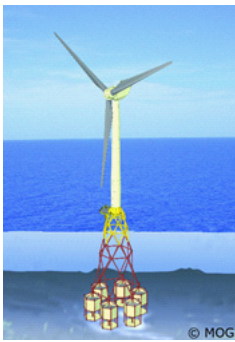
TexBase Gründungsstruktur aus kombiniertem Jacket-Design und Schwergewichtselementen
