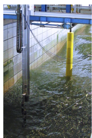
Messungen zur Kolkentwicklung am Schwerkraftfundament mittels Fächerecholot im GWK
