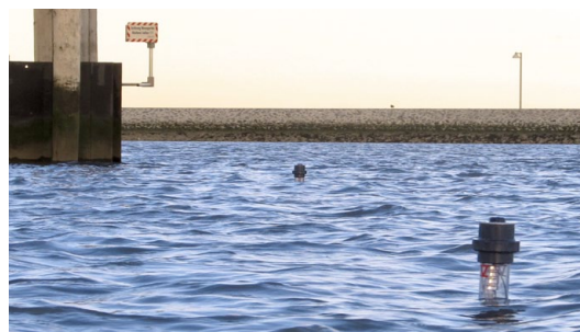
Messung von Strömungsgeschwindigkeiten mittels GPS-Schwimmer in der Einfahrt zum Yachthafen der Insel Juist
